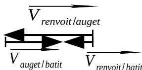
A.5.Dans les conditions optimales toute l'énergie cinétique est transmise à la roue Pelton :
