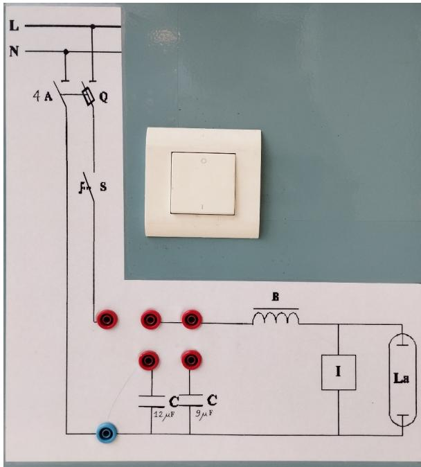
Attention : la lampe ne peut s'allumer qu'à froid. Il faut donc s'assurer que tous les appareils sont correctement réglé et que l'enregistrement est lancé avant d'appuyer sur l'interrupteur pour allumer.
